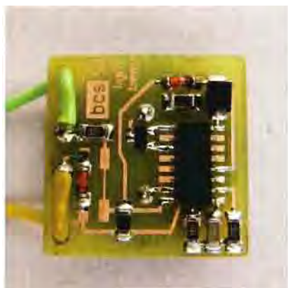
Obr. 4 a 6. Fotografie osazené desky, vrchní strany indikátoru a hotového indikátoru ve směřovací pásce
