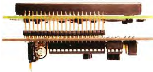
Obr. 8 a 9. Sestavené desky grafického displeje – – pohled zespodu a z boku
