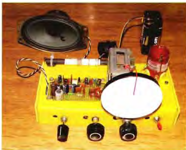
Obr. 2. Příklad konstrukce zpětnovazebního přijímače. Na fotografii je verze pro příjem SV a KV, která bude popsána v dalších číslech
