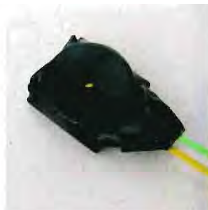
Obr. 4 a 6. Fotografie osazené desky, vrchní strany indikátoru a hotového indikátoru ve směřovací pásce
